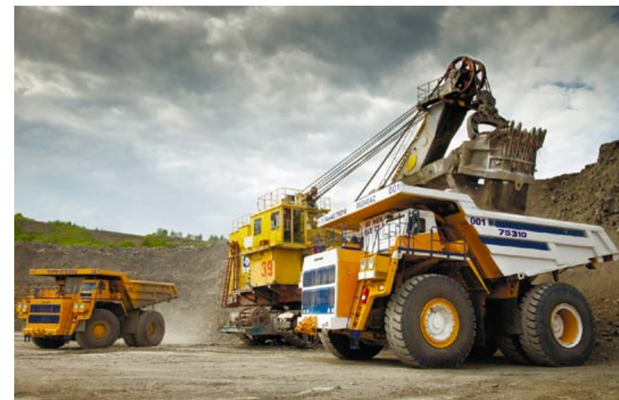
В июне на разрезе «Черниговец» запущен в эксплуатацию уникальный карьерный самосвал БелАЗ-75310 грузоподъемностью 240 тонн
