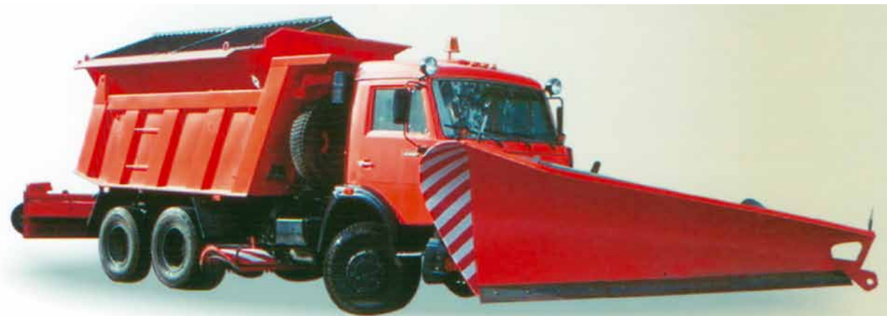
На кемеровском ОАО «КОРМЗ» изготавливается навесное уборочное оборудование, которое укрепляется на базовых автомобилях «КАМАЗ», в результате чего получается комбинированная машина для обслуживания автодорог, чистки снега и т.п.
