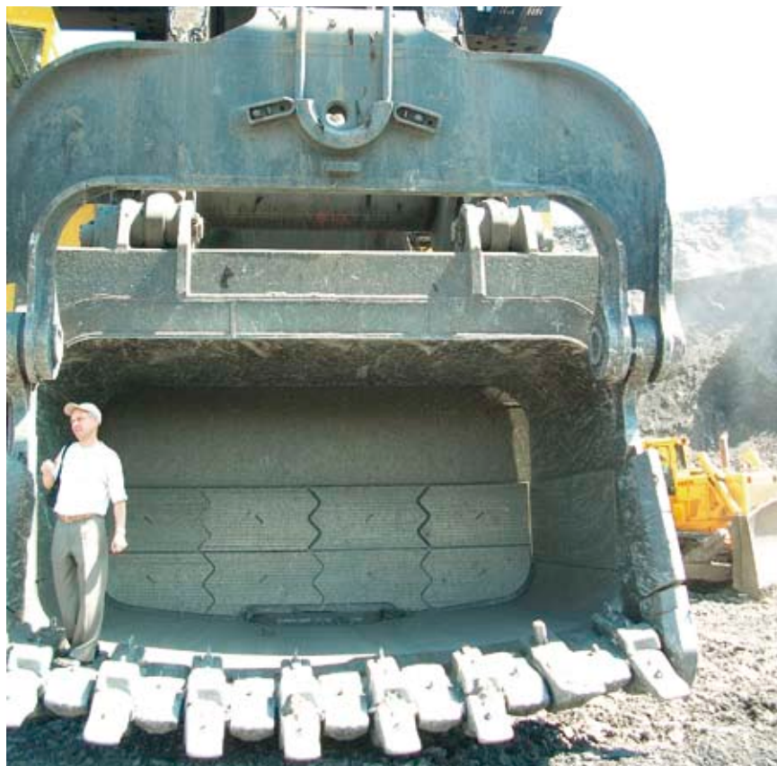
В августе нынешнего года «Кузбассразрезуголь» запустил в работу на Талдинском угольном разрезе вскрышной комплекс на базе нового, самого большого в стране экскаватора P&H 4100 XPC с объёмом ковша 57 кубических метров
