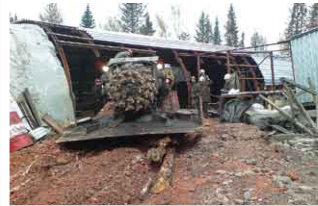
Проходческий комбайн КСП-33 готов к спуску в шахту
